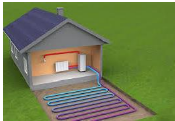
Slika 8: Delovanje TČ (horizontalni kolektor) zemlja – voda
