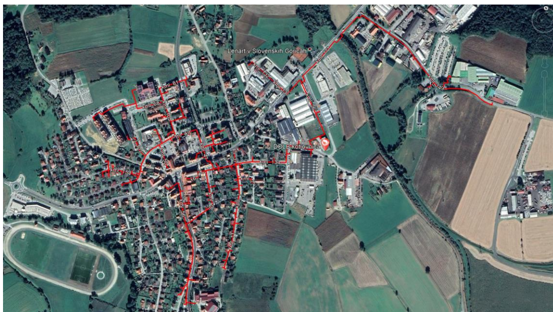
Slika 5: Trasa toplovodnega sistema
