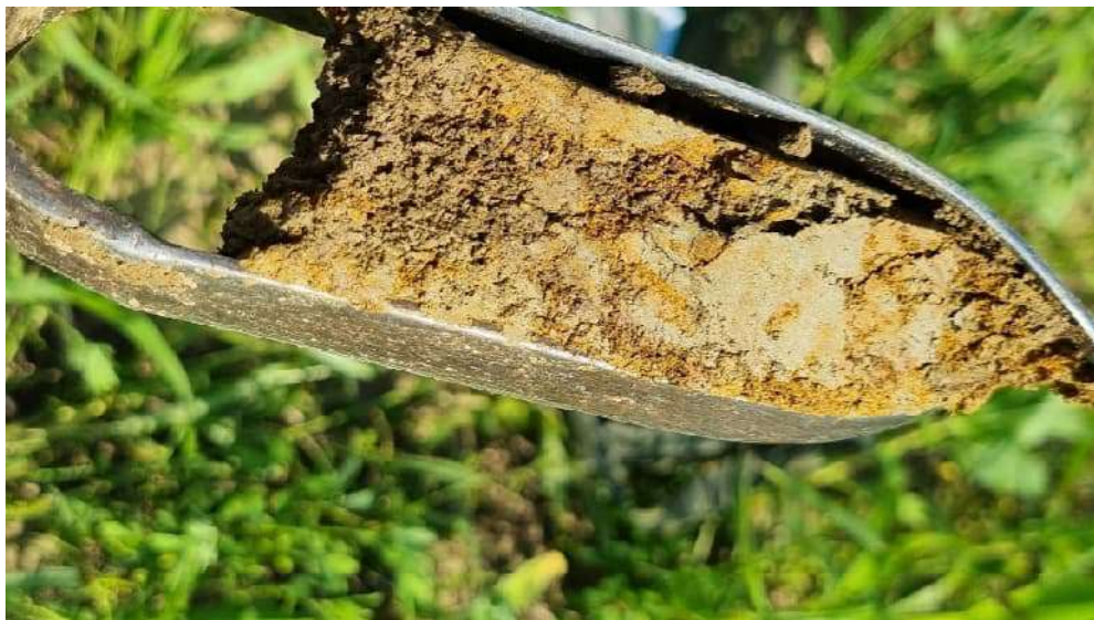
Slika 19: Značilni znaki psevdoglejevanja v Bg horizontu, ki se začnejo v tleh pojavljati pod obdelovalnim Bg horizontom (foto: T. Kralj, 30.8.2024)
