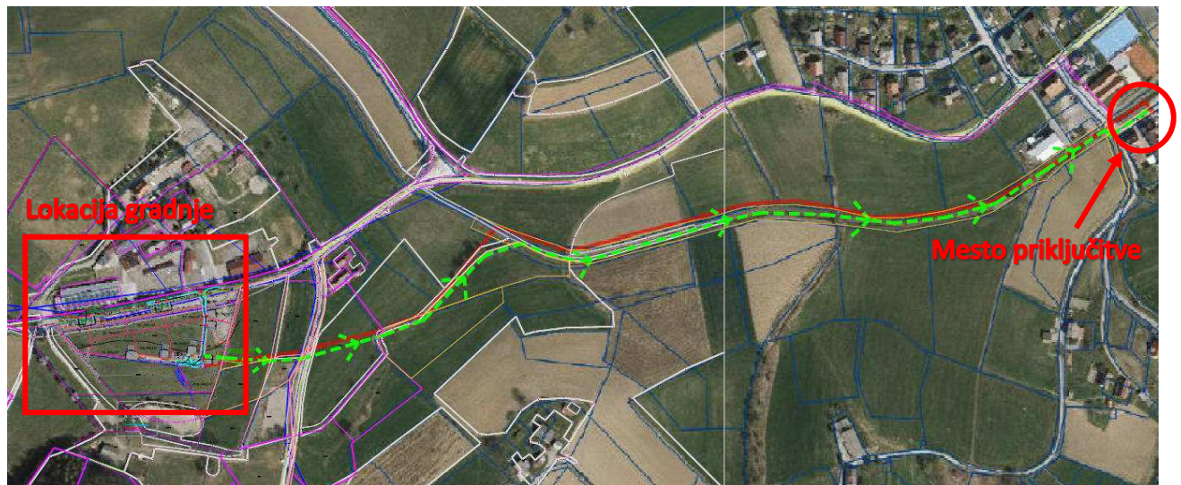
Prikaz celotne trase nove povezave fekalne kanalizacije od mesta gradnje do točka priključna, v naselju.
