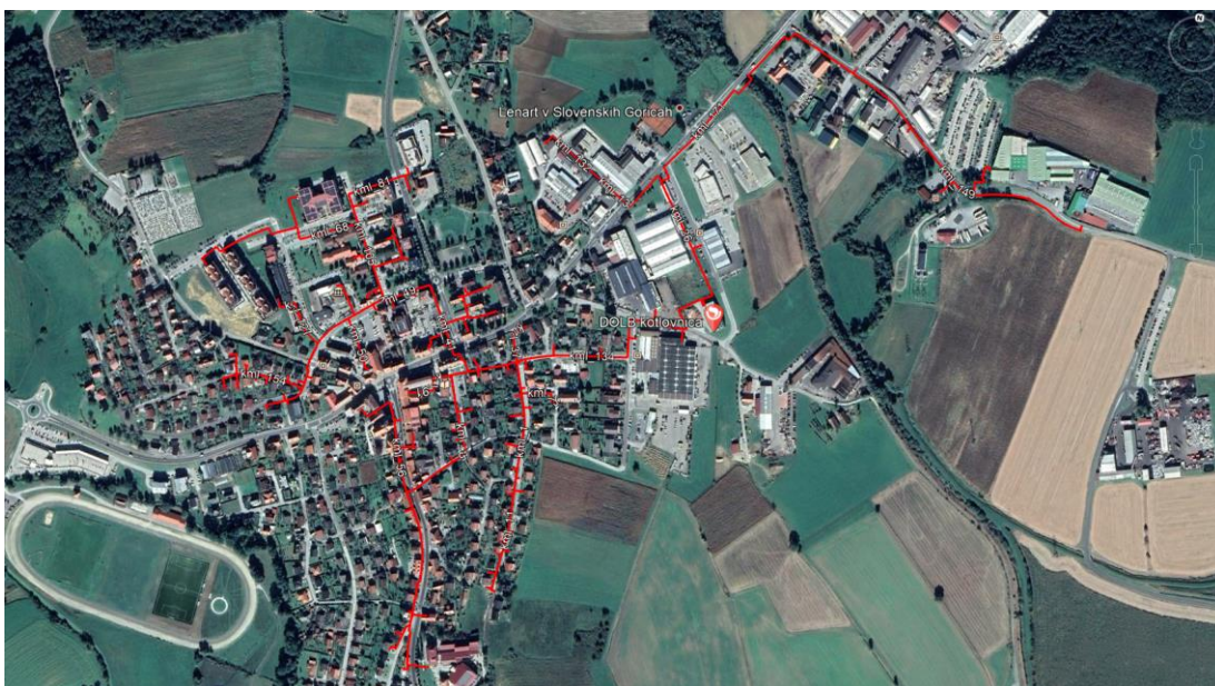
Slika 5: Trasa toplovodnega sistema
